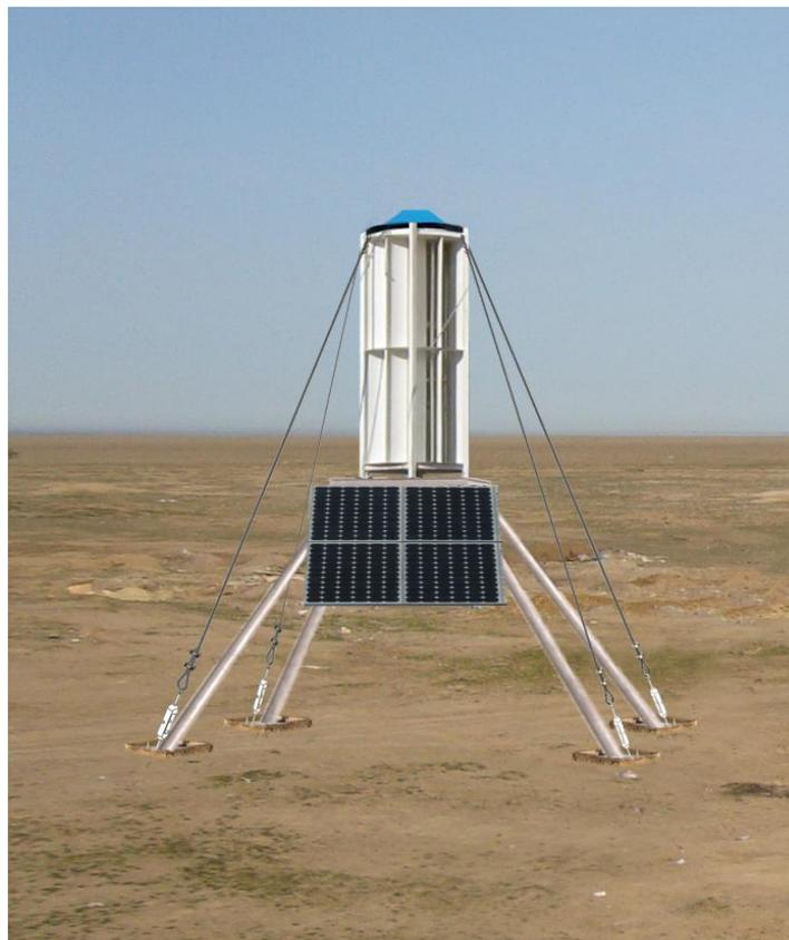
**Рис 10. Комплексная энергетическая система ВРТБ мощностью 1 кВт,
